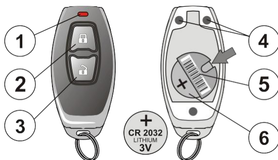
Rysunek: 1 – dioda LED; 2 – przycisk uzbrojenia (włączenia); 3 – przycisk rozbrojenia (wyłączenia); 4 – śrubki obudowy; 5 – nr seryjny; 6 – bateria CR2032
